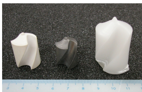
図 3 焼結体およびマスターパターン（左から \text{Al}_2\text{O}_3 ，WC-Co，マスターパターン）
