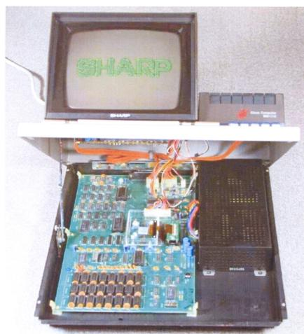
図 8 ガラス CPU を搭載したパソコン
